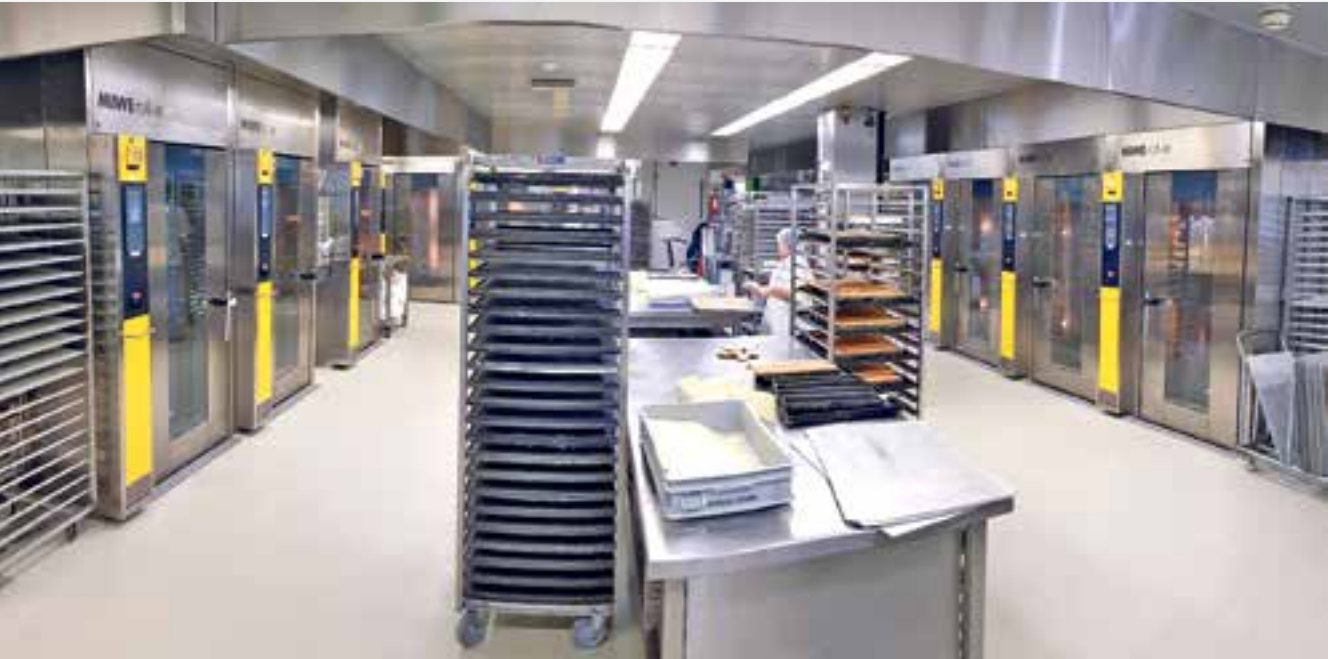
Die alten Backöfen wurden durch neue, energieeffiziente Öfen mit einem grösseren Wärmespeicher ersetzt
